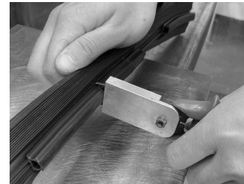
Ausklungung mit Klinkschere Art.Nr.939400 Encochage avec cisaille d'encochage art. no. 939400 Notching with ratchet-shears art. no. 939400
